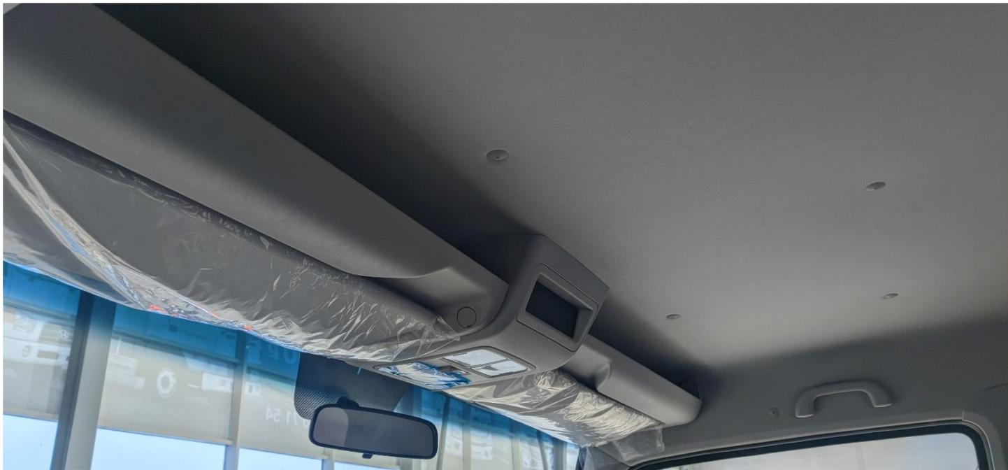
Для установки требуется снять пластиковую обшивку места для установки тахографа:
