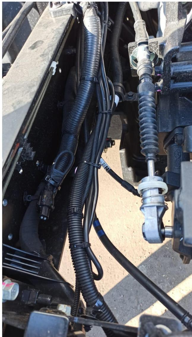
Ввод кабеля датчика движения в салон автомобиля происходит в центральной части кабины. Требуется выкрутить 4 винта крепления решётка радиатора (1), место ввода кабеля находится в районе ног водителя (2)
