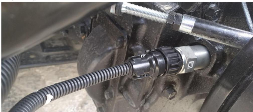
Кабель для подключения датчика движения продеть в гофрированную трубку и протянуть до места установки тахографа, закрепив пластиковыми стяжками:
