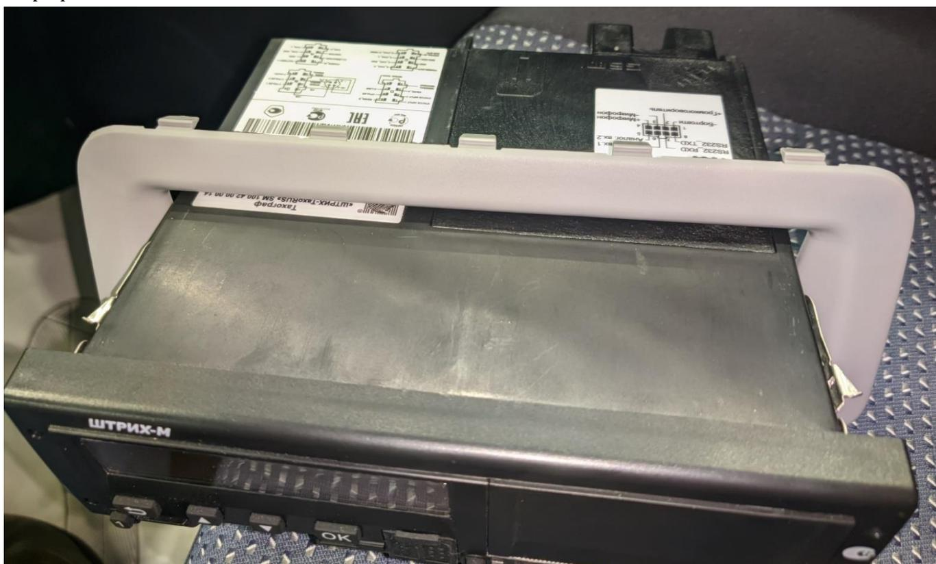
Утопить тахограф в пластиковую обшивку, чтобы фиксаторы тахографа оказались внутри:
