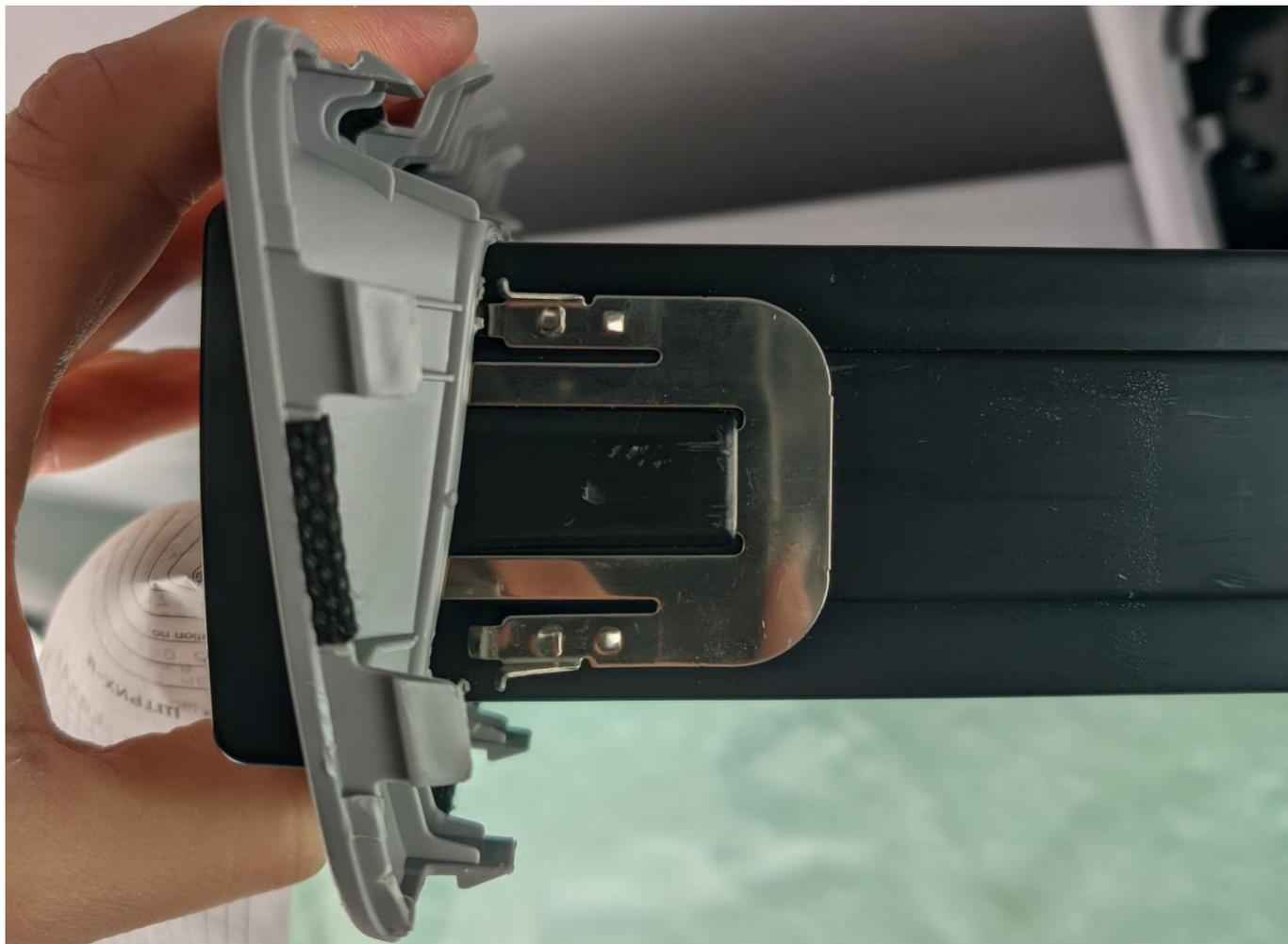
Подключите разъёмы питания и антенну к тахографу. Установите пластиковую обшивку с тахографом на место и зафиксируйте её:
