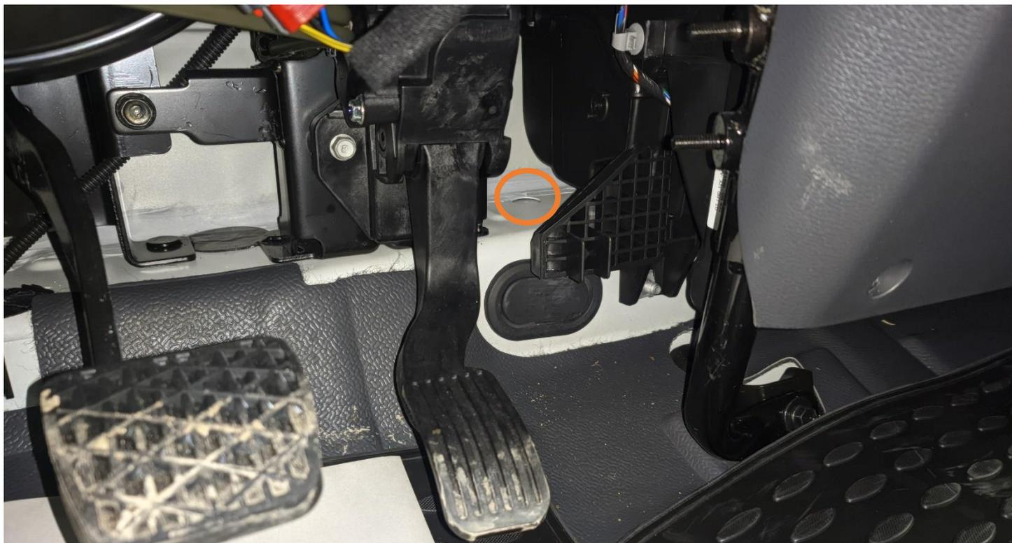
После ввода в салон автомобиля кабель датчика движения прокладывается вправо (в ноги пассажира), откуда вместе с проводами питания тахографа по правой стойке кабины прокладываются к месту установки тахографа, данные операции описаны в следующем пункте инструкции.
