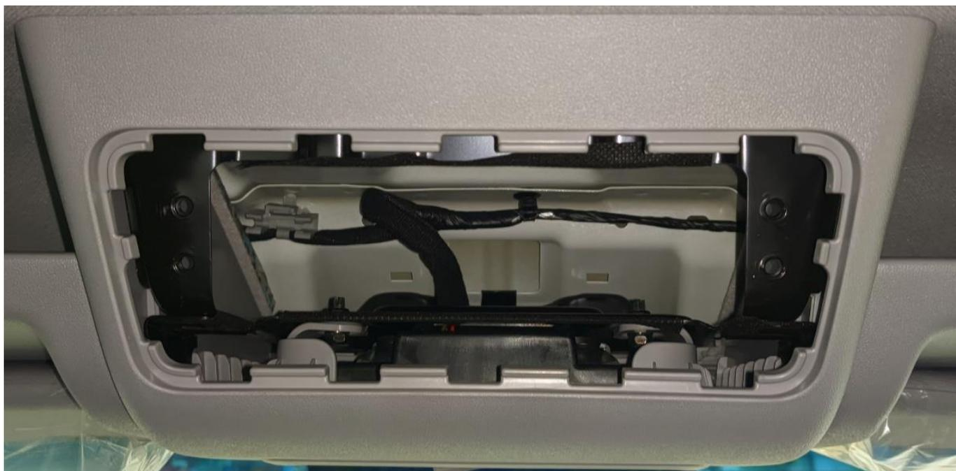
Тахограф устанавливается в пластиковую обшивку без использования установочной рамки тахографа:
